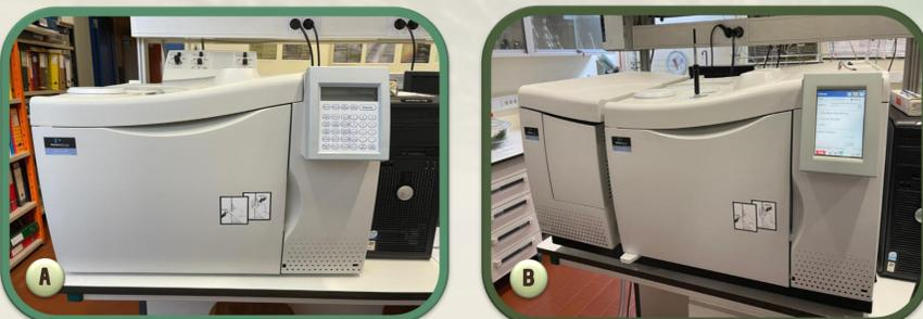
Fig. 3 - A. Cromatógrafo de gás (GC); B. Espectrómetro de massa (GC-MS) com a agulha de SPME inserida.
