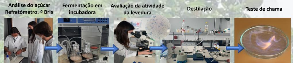
Fig.2-Análise do teor em açúcar, fermentação, análise da atividade da levedura, destilação e teste de chama
