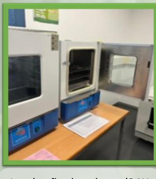
Incubação das placas (24h a 36º) e posterior medição do crescimento microbiano à volta do disco
