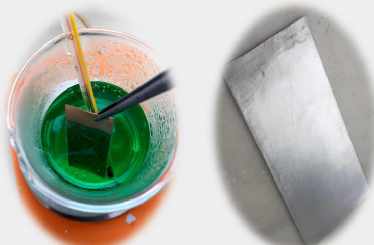
Fig. 4 - A - Mergulho da chapa no banho B - Aspeto do resultado final (chapa de Cu + filme de Ni)
