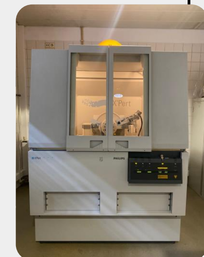
Fig. 5 - Máquina que realiza a DRX a analisar chapas de Cu e Chapas de Cu + Ni
