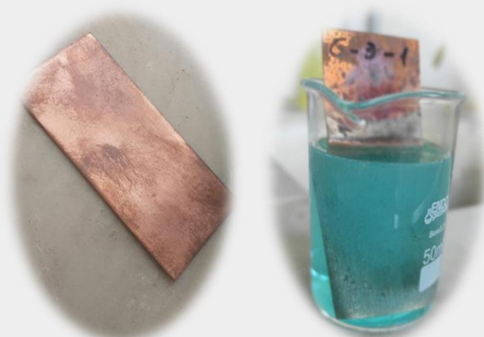
Fig. 3 - A - Polimento da Chapa com lixa B - Banho em Solução à base de HCl
